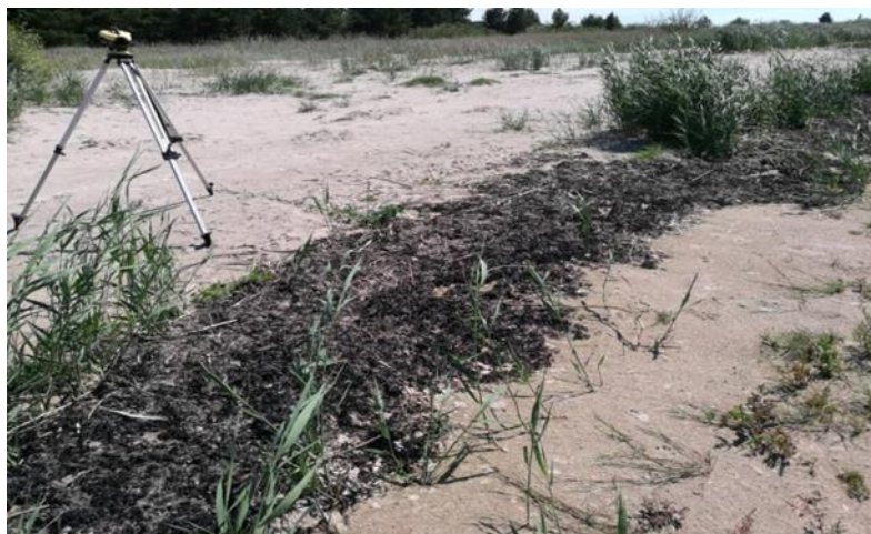
17.attēls. Krasta šķērsprofilu uzmērīšana nivelējot
